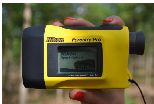
Figura 5: Alguns dos equipamentos utilizados em campo A) Hipsômetro – Nikon Forestry Pro B) Fita Métrica
